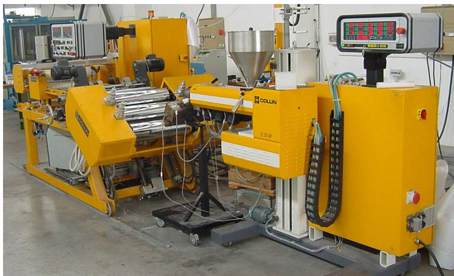
Ilustración 1. Imagen de conjunto extrusora-calandra para lámina plana.
