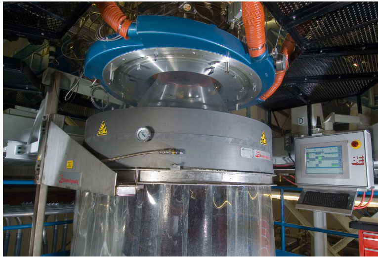
Ilustración 18. Proceso de extrusión soplado hacia abajo. Sistema Aquafrost® (Brampton Engineering)
