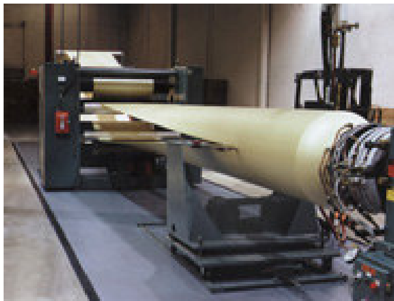
Ilustración 21. Vista del sistema de corte, recogida y bobinado de lámina espumada.
