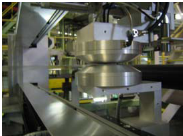
Ilustración 22. Vista en funcionamiento del sistema de control de espesores capacitivo C-Scan.
