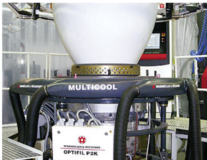
Ilustración 17. Vista de cabezal con sistema de control de espesores Optifil (Windmüller & Hölscher).
