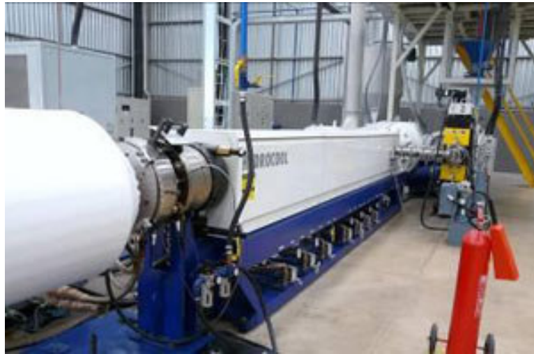
Ilustración 20. Vista del sistema tándem de extrusión de láminas espumadas
