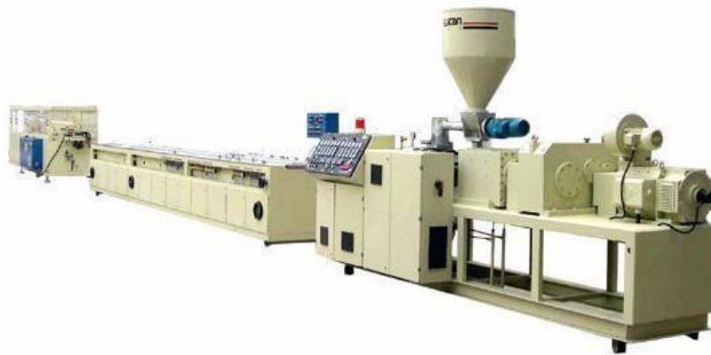
Ilustración 4. Esquema de una línea de extrusión de perfiles.
