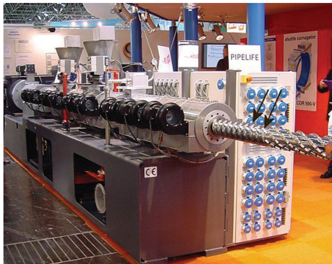
Ilustración 8. Extrusora monohusillo DREX 120-55 para compounding de Rollepaal.
