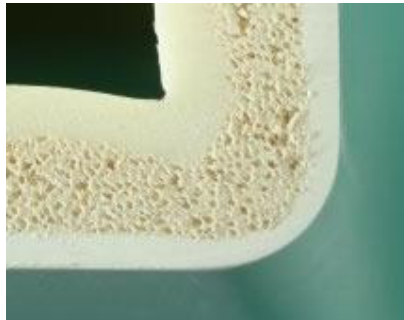
Ilustración 14. Ejemplo producto obtenidos por rotomoldeo con núcleo espumado.
