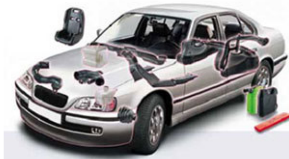
Ilustración 12. Partes de automóvil fabricadas por extrusión soplado tridimensional (3D).
