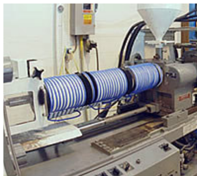
Ilustración 7 Calentamiento de cilindro de extrusora mediante sistema nXHeat TM .
