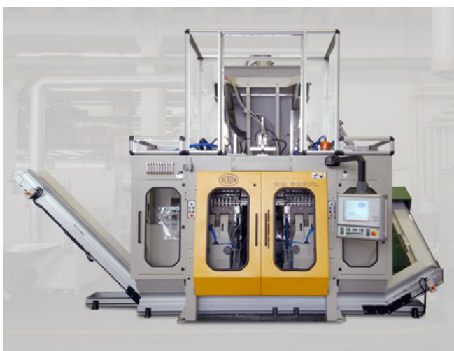
Ilustración 16 Máquina pequeña de moldeo por soplado con alto rendimiento (multicavidad): Bekum BM 506 DL (D=Double Station / L = Long Stroke).
